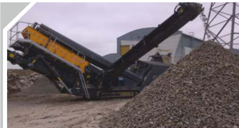
Мобильный грохот TESAB TS1230 Для разделения вторичного щебня на фракции
